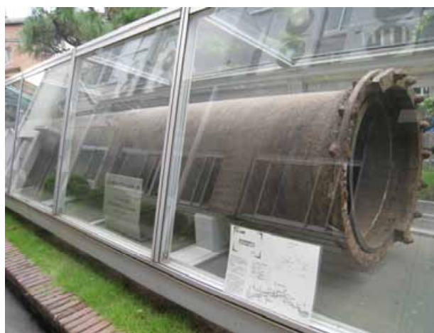
わが国第一号の遠心力ダクタイル鉄管
